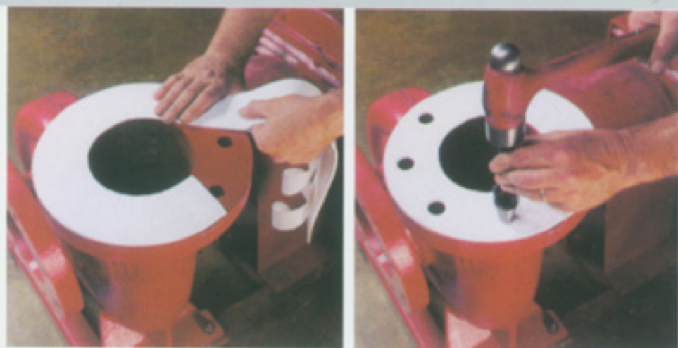
▲ 只需将垫片按法兰形状贴于表面，首尾相叠，截成相应长度。而后用打孔器或其它锐器直接在法兰上钻出螺栓孔。
